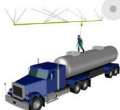
LINHA DE VIDA EM TRILHO AÉREO ATIRANTADO POR CABO
