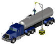
LINHA DE VIDA MÓVEL BASE CONCRETADA
