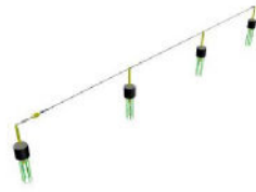
LINHA DE VIDA EM TALUDE
